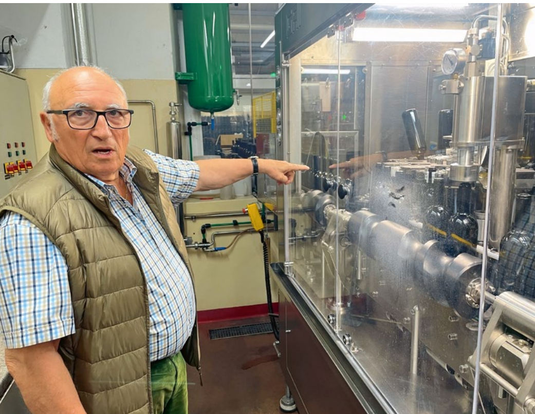
Abb. 2: Feliciano Gialdi zeigt die neue, vollautomatische Abfüllanlage, die 2500 Flaschen pro Stunde bewältigt: vom Tank bis in den Karton, versteht sich. (© O+W)
